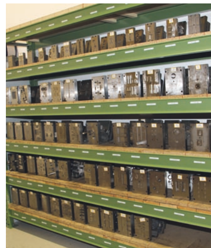
Gegenüber vergleichbaren Komplettwerkzeugen lassen sich die Wechseleinsätze sehr platzsparend lagern.
