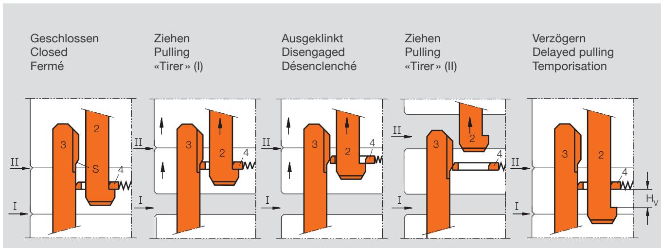
Die Reihenfolge des Zusammenfahrens des Werkzeugs ist grundsätzlich beliebig. Muss eine bestimmte Folge aus Funktionsgründen eingehalten werden, sind entsprechende konstruktive Maßnahmen zu treffen.
