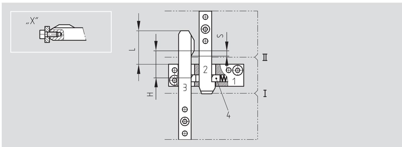
Die Positionierung des Klinkenzuges und Festlegung des Hubes erfolgt unter Berücksichtigung der in den Maßblättern orange eingetragenen Maße. Der Hub der gezogenen Platte muß begrenzt werden, dieses kann z.B. nach Einzelheit „X“ erfolgen.
