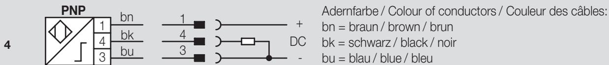
Bei in Reihe angeschlossener Zylinder ist darauf zu achten, dass sich die Betriebsspannung um 2 V je Näherungsschalter reduziert.
